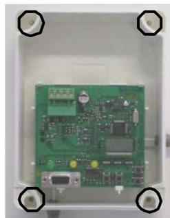
Figura 6 - orificios para los tornillos
